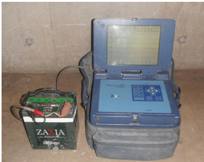
測定器 (サスペンションPS Logger Model SX)
